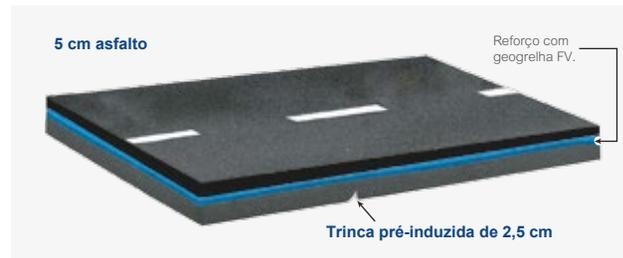
Em um teste de propagação de trinca, as geogrelhas de fibra de vidro suportam entre 5 e 10 vezes mais ciclos de carga do que uma amostra padrão sem reforço, enquanto a geogrelha sintética (Poliéster-PET) suporta apenas 1,5 vezes mais ciclos de carga, até que a trinca se propague para a superfície.
