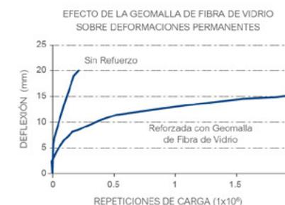
Para alcanzar la misma deformación de 15 mm, la muestra reforzada con Geomalla de Fibra de Vidrio soportó 18 veces más ciclos que la muestra sin refuerzo.
