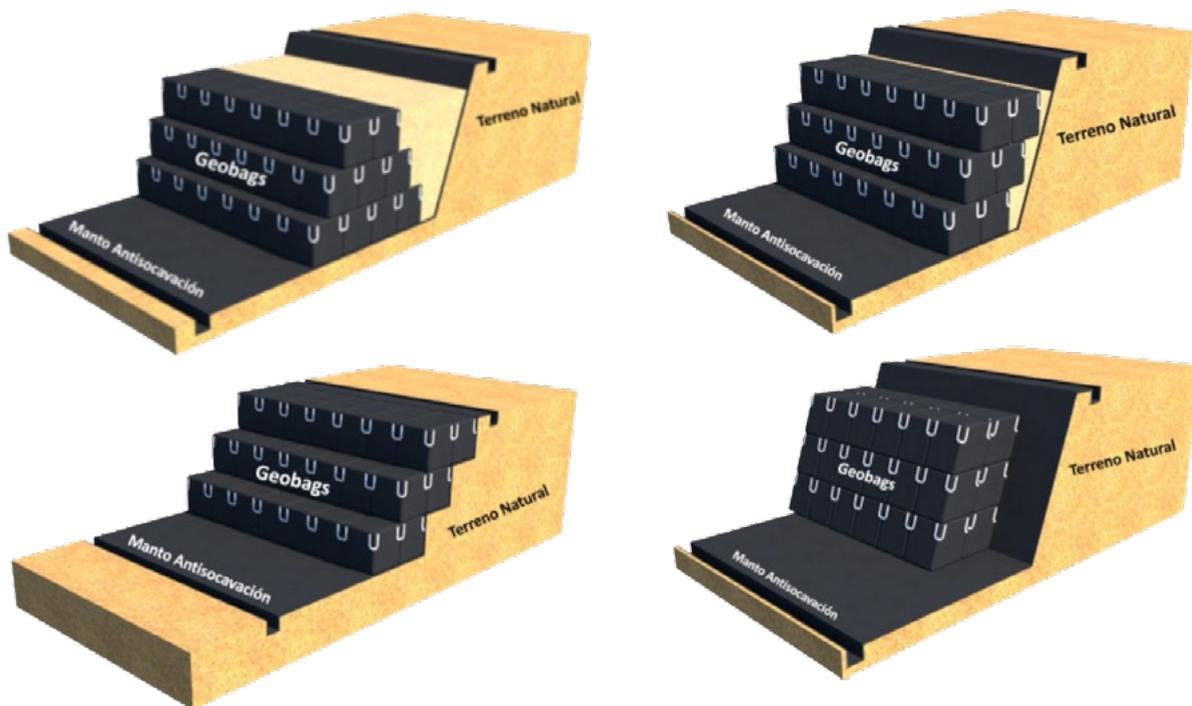
▲ *Figura 17.1 | Configuraciones geométricas estructuras de protección con Geobags.*
