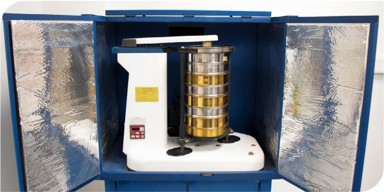
▲ Fotografía 2.30 | Ensamble ensayo tamaño de abertura aparente.
