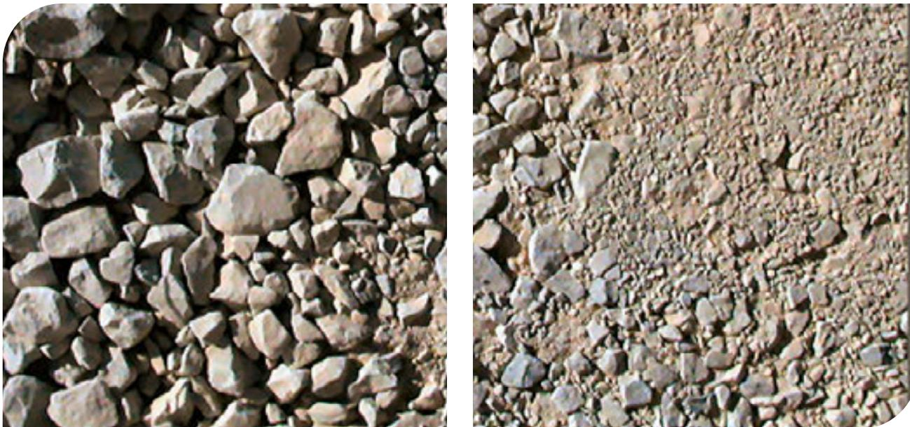
▲ *Fotografía 11.4 | Materiales que generan trabazón/materiales que generan fricción, con el Geosintético de Refuerzo.*
