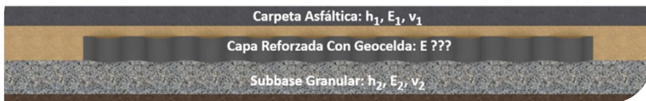
▲ Figura 7.11 | Esquema de esfuerzos y deformaciones para la estructura con y sin refuerzo.
