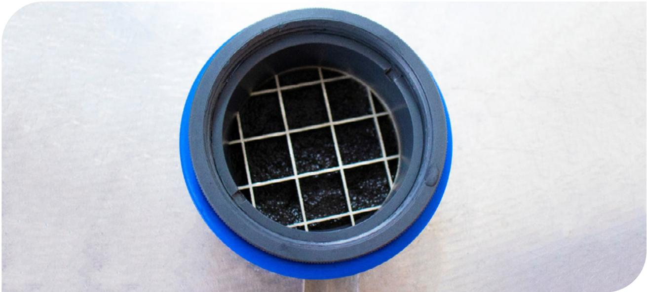
▲ Fotografía 2.26 | Ensamble de Geotextil para ensayo de permitividad.
