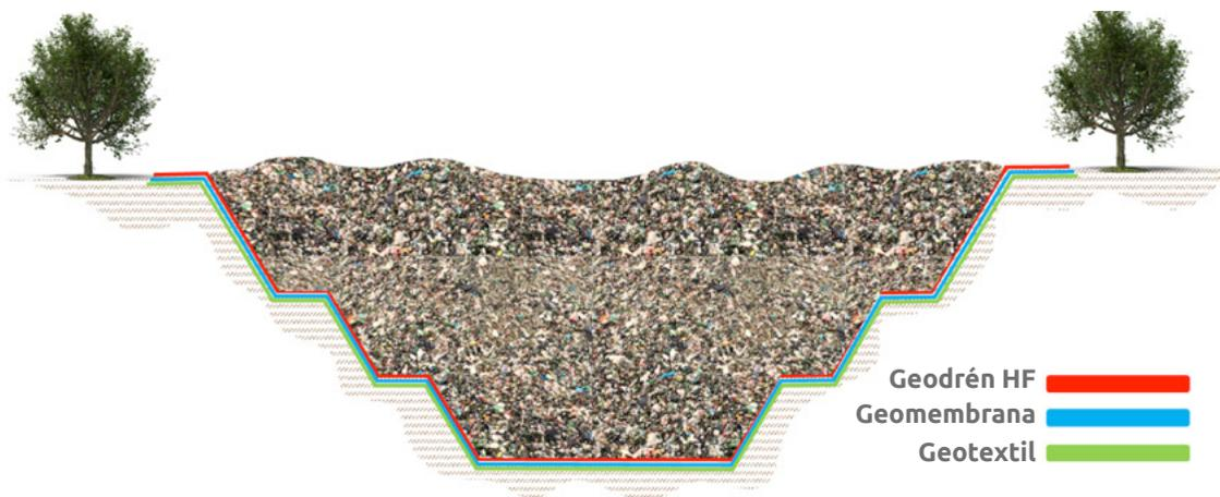
▲ Figura 10.8 | Subdrenaje en rellenos sanitarios con geocompuestos de drenaje.
