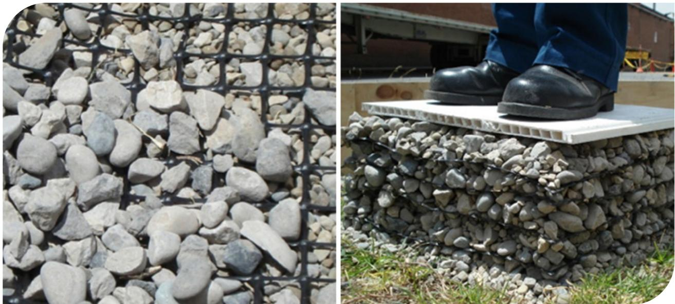
▲ Figura 6.2 | Confinamiento lateral generado por la Geomalla en un material granular.
