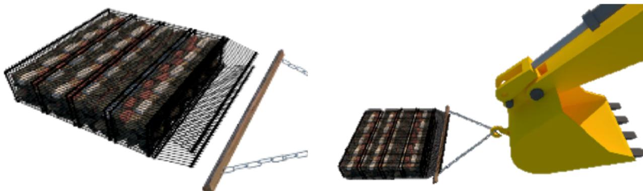
▲ Figura 17.17 | Conformación del triángulo para izado.
