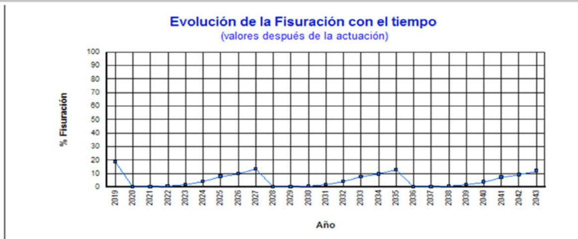
▲ Imagen 8.26 | Simulación de deterioro de pavimento flexible con alternativa "Capa de Refuerzo" en HDM4.
