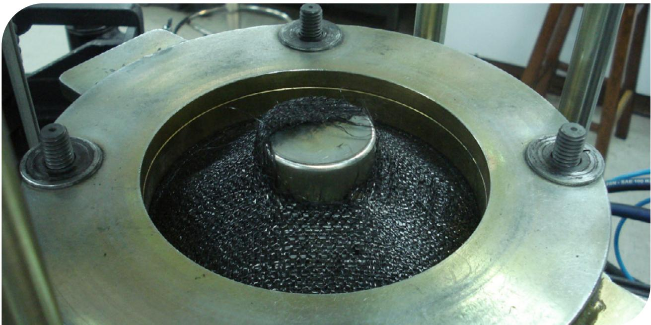
▲ *Fotografía 2.33 | Finalización ensayo punzonamiento estático.*
