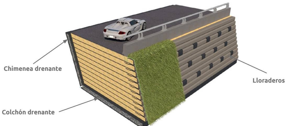
▲ Figura 9.4 | Subdrenaje en muros de contención.
