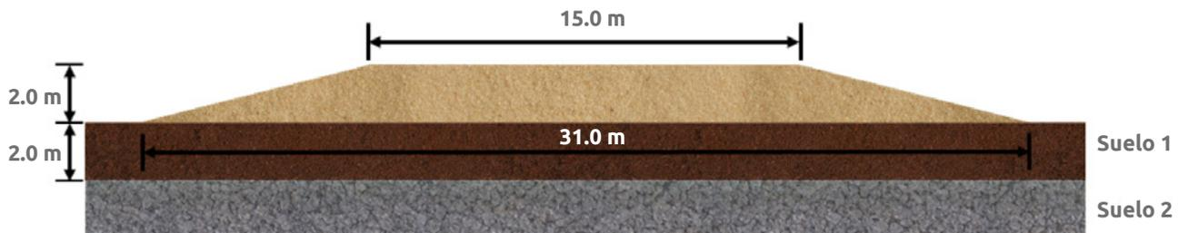
▲ Figura 13.12 | Sección típica del terraplén.
