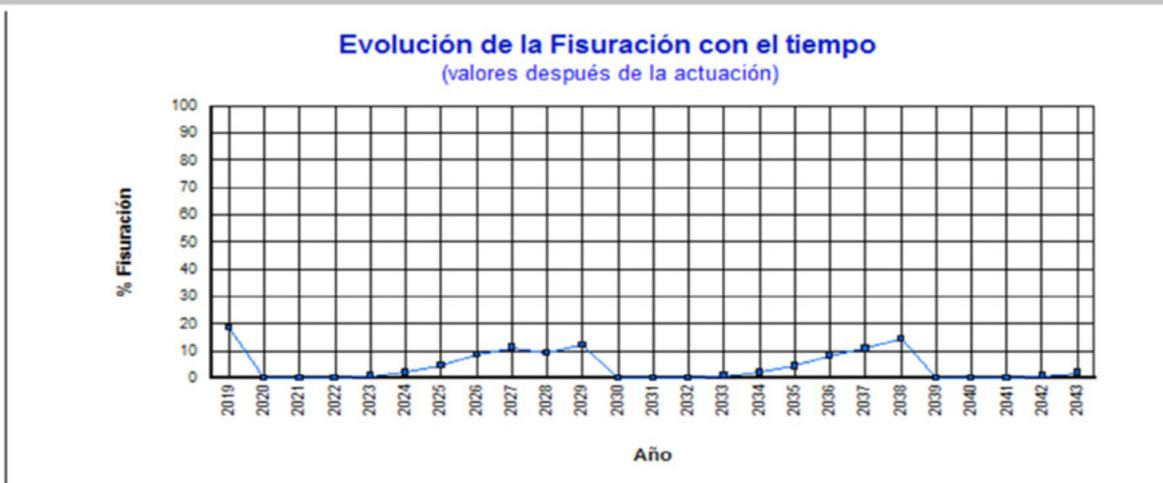
▲ Imagen 8.27 | Simulación de deterioro de pavimento flexible con alternativa "Geosintético y Capa de Ref." en HDM4.
