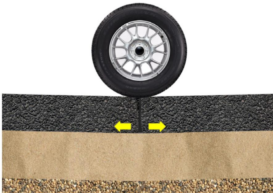
▲ Imagen 8.11 | Esquema de fisura por fatiga.
