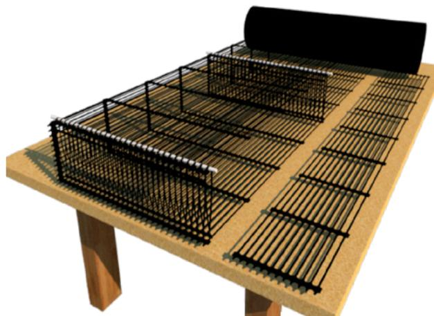
Figura 17.15 | Ensamble de laterales y tapa superior.
