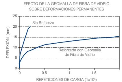
Para alcanzar la misma deformación de 15 mm, la muestra reforzada con Geomalla de Fibra de Vidrio soportó 18 veces más ciclos que la muestra sin refuerzo.
