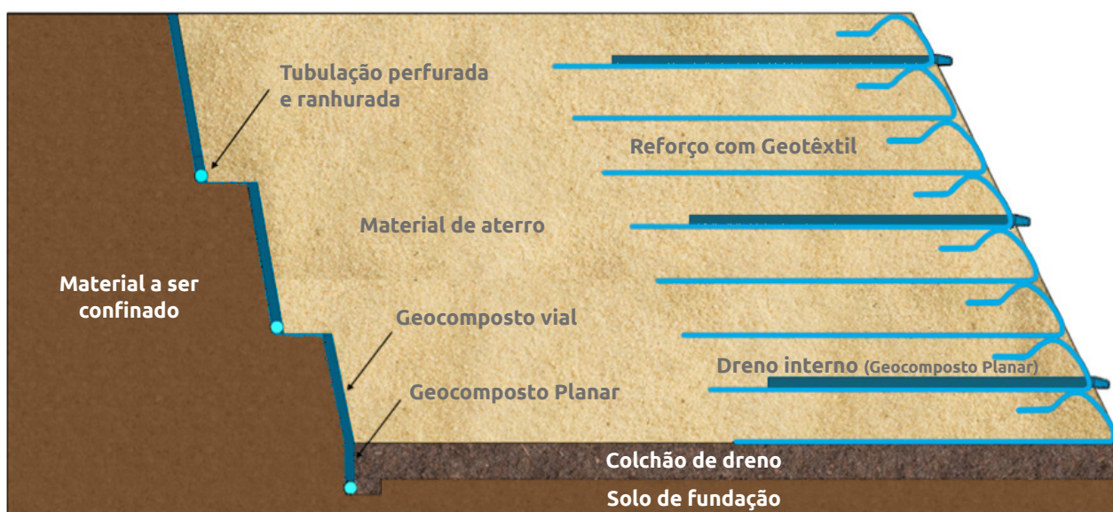
▲ Figura 12.6 | Esquema de obras de subdrenagem em um aterro.
