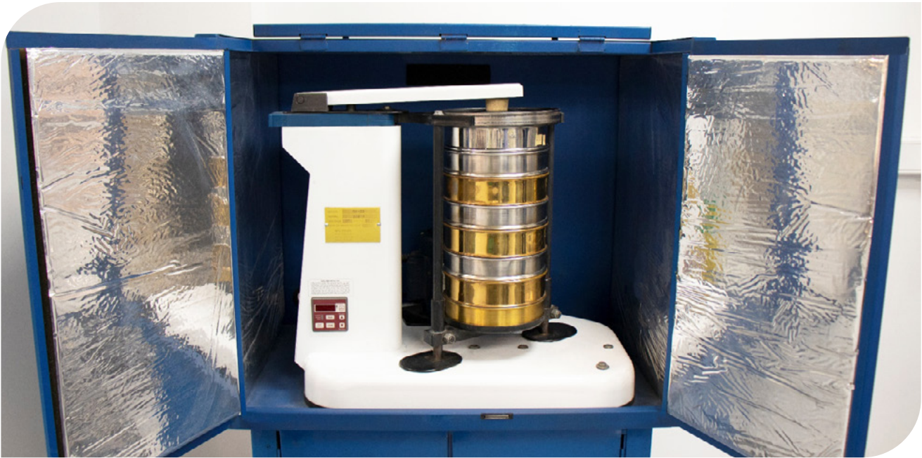
▲ Fotografia 2.30 | Conjunto de ensaio de tamanho de abertura aparente (TAA).
