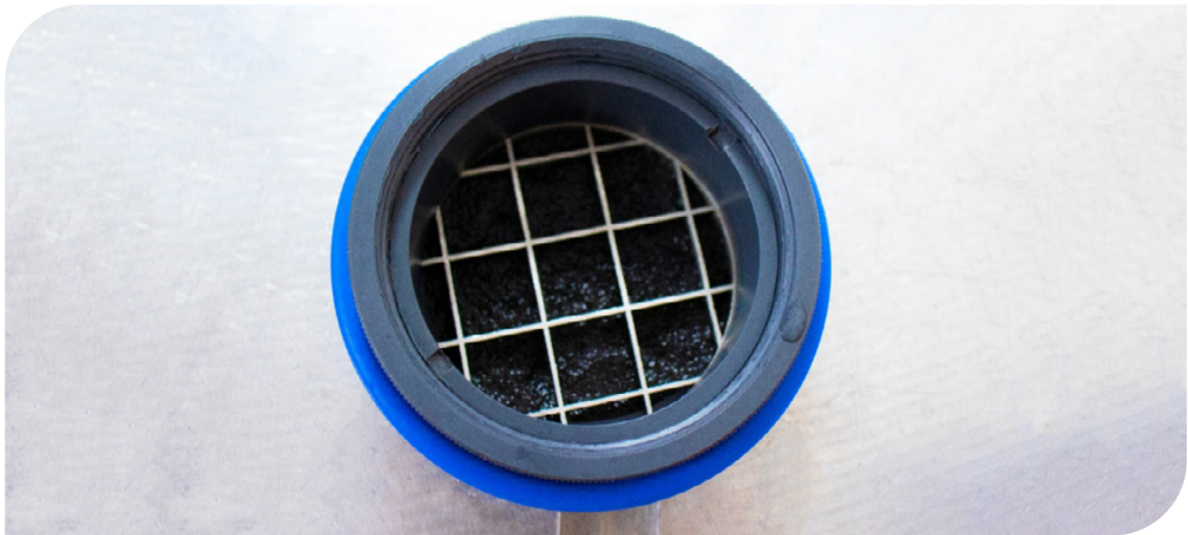
▲ Fotografia 2.26 | Conjunto de Geotêxtil para ensaio de permissividade.
