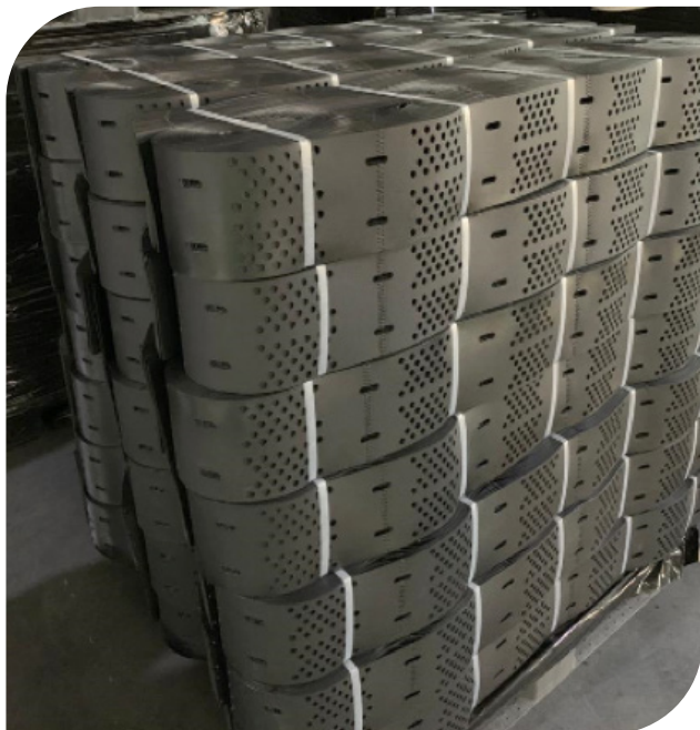
▲ Figura 4.6 a | Painéis embalados para fácil transporte e manipulação. Figura 4.6 b | Geocélula expandida pronta para ser preenchida.
