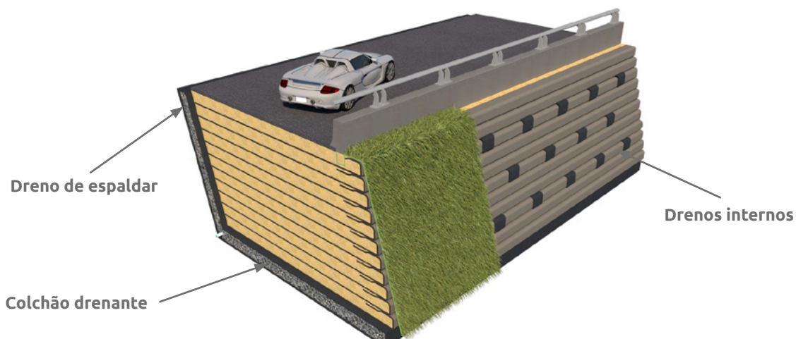
▲ Figura 9.4 | Subdrenagem em muros de contenção.
