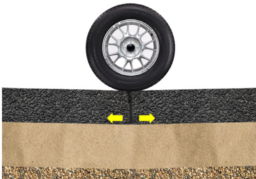
▲ Imagem 8.11 | Esquema de trinca por fadiga.
