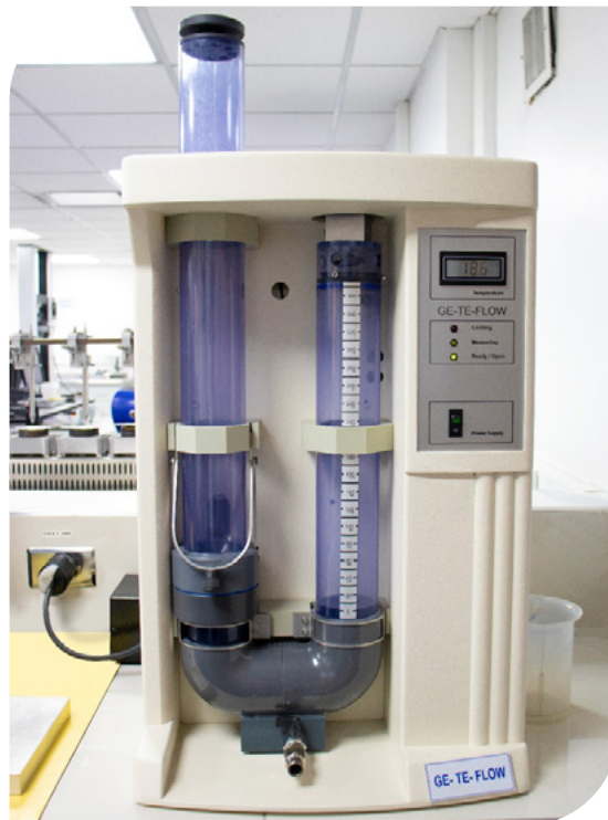
▲ Fotografia 2.25 | Início do ensaio de permissividade.
