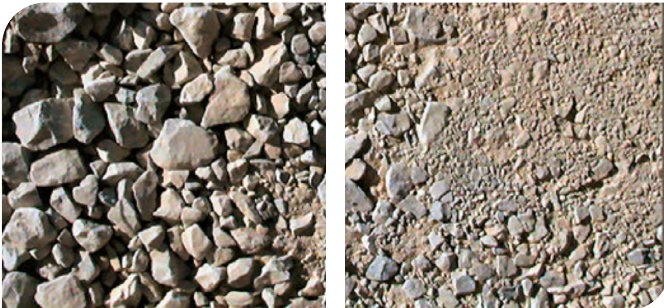
▲ Fotografia 11.4 | Materiais que geram travamento/materiais que geram fricção, com o Geossintético de Reforço.
