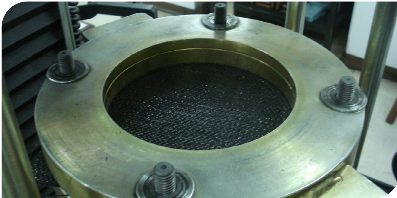
▲ Fotografia 2.32 | Início do ensaio de método de puncionamento estático.
