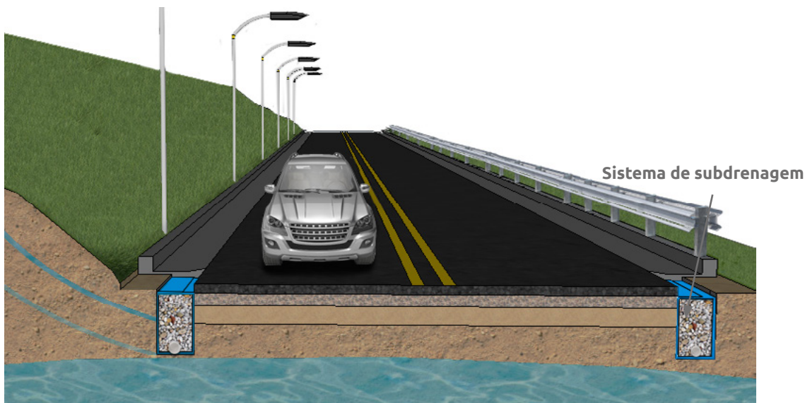
▲ Figura 9.2 | Subdrenagem em estradas.
