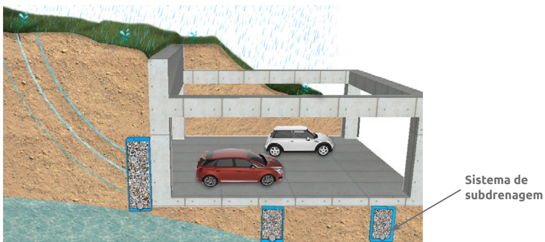
▲ Figura 9.5 | Subdrenagem em edificações.
