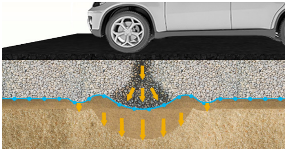
▲ Figura 6.3 | Melhoramento da capacidade de carga ao empregar uma Geogrelha de reforço.
