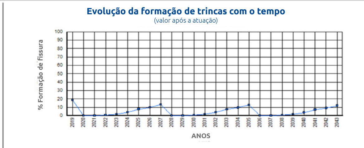
▲ Imagem 8.26 | Simulação de deterioração de pavimento flexível com alternativa “Camada de Reforço” em HDM4.
