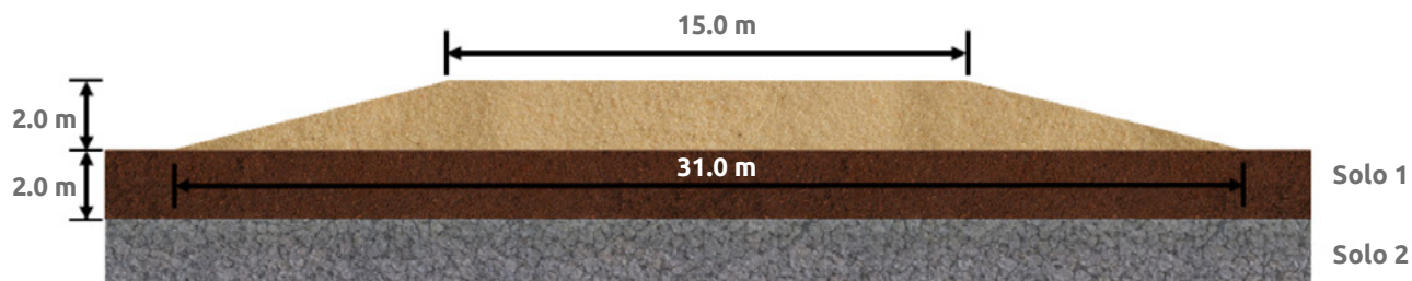
▲ Figura 13.12 | Solo para a construção do aterro.
