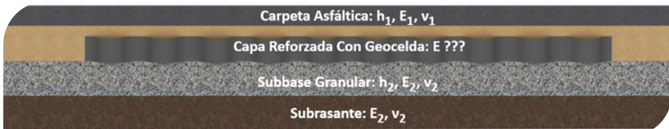
▲ Figura 7.11 | Esquema de esfuerzos y deformaciones para la estructura con y sin refuerzo.
