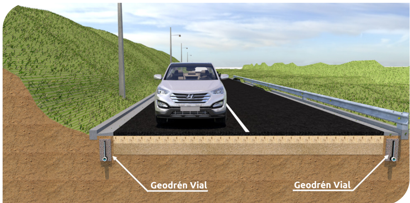
▲ Figura 10.4 | Subdrenaje en carreteras con Geodrén Vial.
