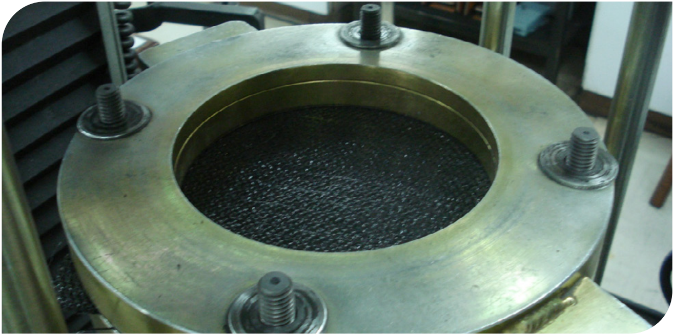
▲ Fotografía 2.32 | Inicio ensayo punzonamiento estático.
