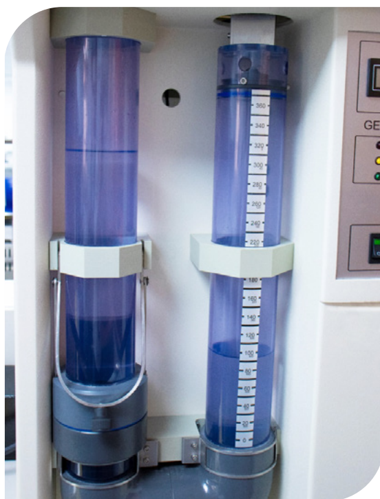
▲ Fotografía 2.27 | Final ensayo permitividad.
