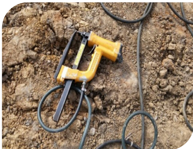
▲ Fotografía 17.49 - 17.50 | Elementos de unión de los paneles a. Grapadora mecánica; b. Anclaje mecánico.
