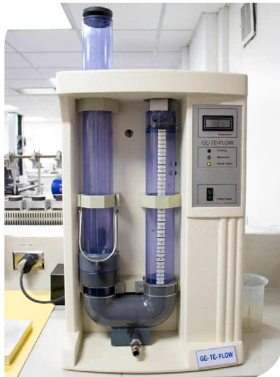
▲ Fotografía 2.25 | Inicio de ensayo permitividad.
