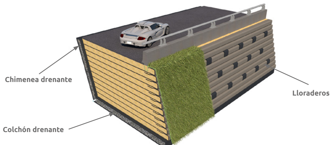
▲ Figura 9.4 | Subdrenaje en muros de contención.
