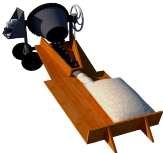
▲ Figura 17.21 | Llenado por gravedad.
