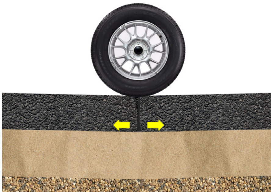
▲ Imagen 8.11 | Esquema de fisura por fatiga.
