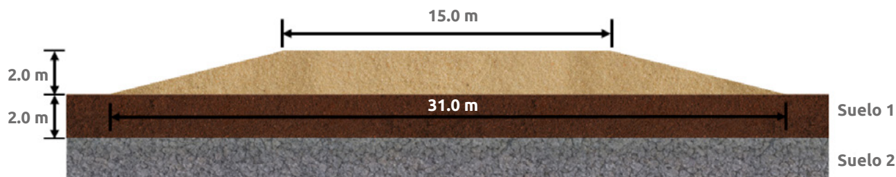
▲ Figura 13.12 | Sección típica del terraplén.
