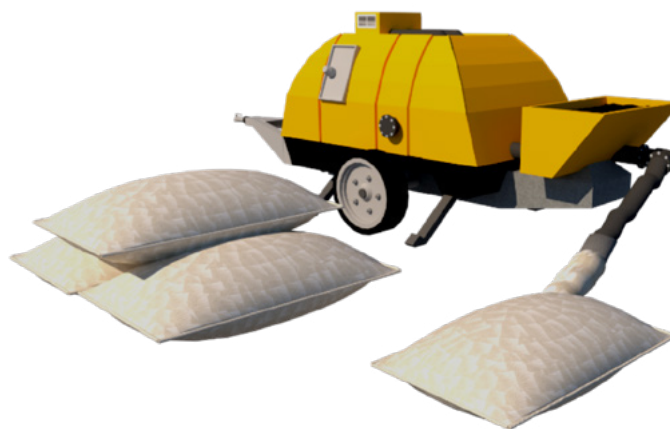
▲ Figura 17.22 | Llenado con equipo de bombeo.
