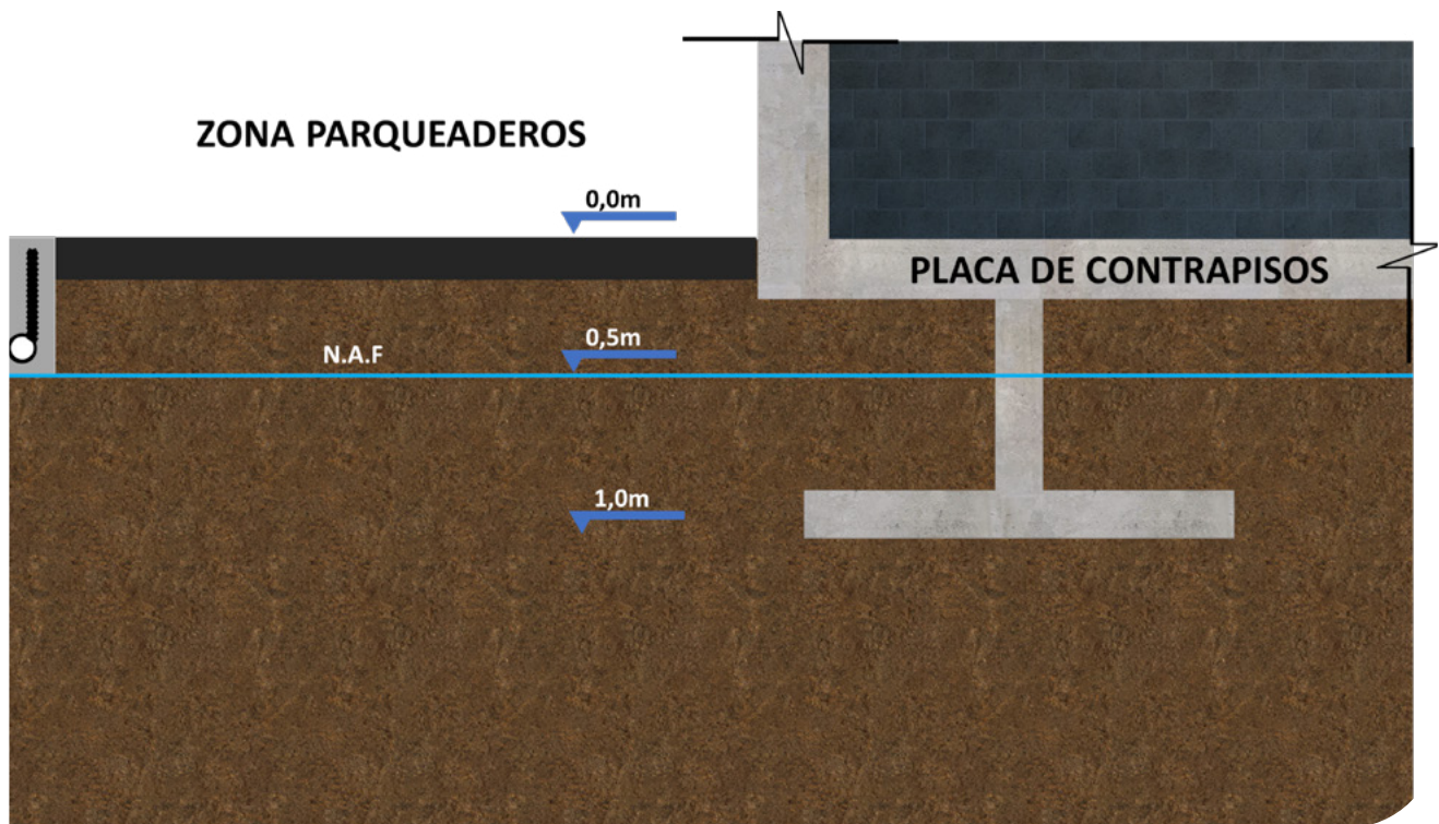
▲ Figura 10.26 | Esquema ejemplo sistema de sub-drenaje.
